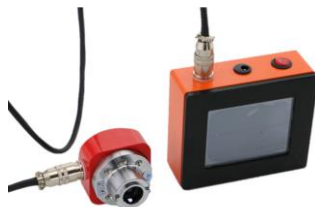
M. Ancho de grietas JW-JWCK102
