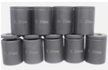
Celda de calibración de espesor de referencia
