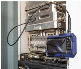
Abb. 7: Endoskop auf Fläche gestellt und mit Magnet fixiert
